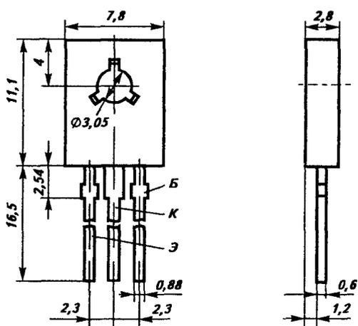
Транзистор кремниевый эпитаксиально-планарный структуры p-p-n переключающий. Предназначен для применения в переключающих и усилительных схемах. Выпускается в пластмассовом корпусе, тип корпуса КТ 27-2. Масса транзистора не более 0,6 г.
