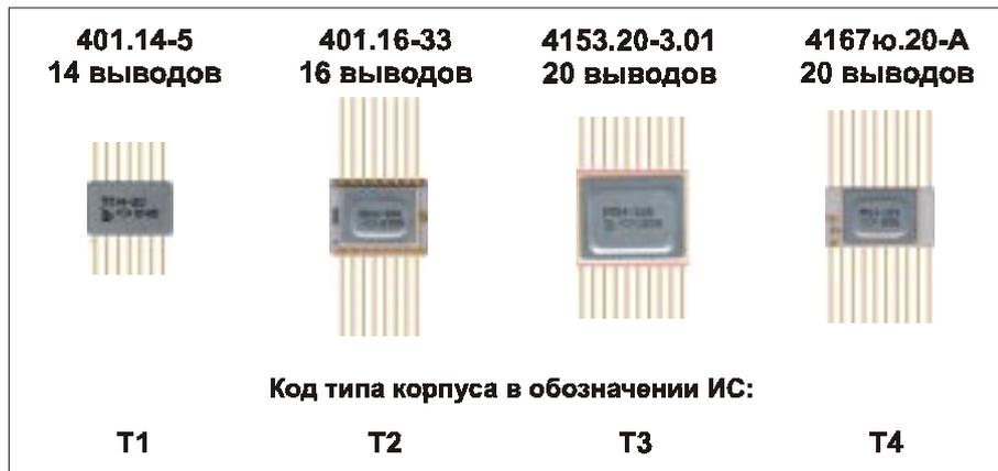
**Рис. 1. Корпуса ИС серии 5514**
