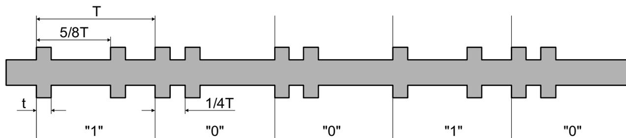
Период передаваемого бита  $T=110\div 160$  мкс и длительность позиционного импульса  $t=1/16T=7\div 10$  мкс определяются внутренним генератором и качеством согласования радиоканалов идентификатора и считывателя.
